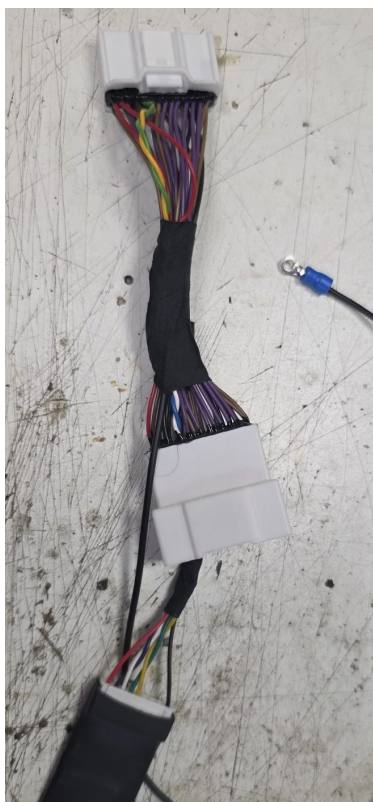
Разъемы адаптера и отдельный провод GND.
